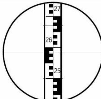
8. Определите расстояние от прибора до рейки
